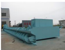
浅圆仓出仓装置加工现场
